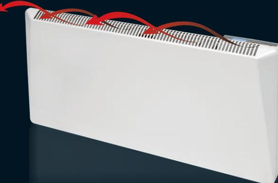
SIRIO vă va încălzi casa prin convecție naturală - aerul rece trece prin grila inferioară, este încălzit de rezistența de aluminiu și ieșe prin grila de sus, încălzind perfect mediul înconjurător, în condiții de siguranță și fără zgomot, deoarece nu există părți mecanice în mișcare. Termostatul electronic oferă o gestionare inteligentă a căldurii, reducând automat consumul atunci când temperatura atinge nivelul necesar.
